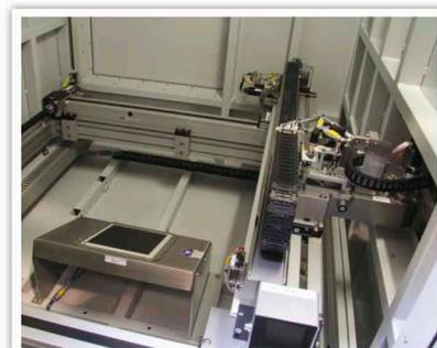
*l'installation. Composé d'une cabine blindée, d'un manipulateur, de convoyeurs d'entrée et de sortie, d'un générateur RX 160kV, d'un détecteur digital et plus encore, l' AIS500 est la réponse évidente à toutes entreprises désirant inspecter leurs pièces à n'importe quelles étapes de fabrication.*
